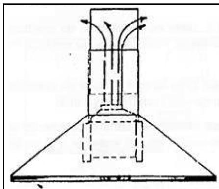
KIVEZETÉSES ÜZEMMÓD: A gőzök és párás levegő a falon belül húzódó kivezető csövön keresztül kerülnek ki a szabadba. A kivezető csövet a készülék belsejében található a motornál elhelyezett csőcsatlakozáshoz kell kötni. (2. rajz – Fig.2. )
