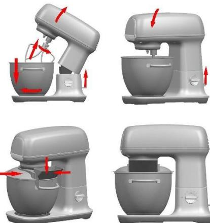
Vaše příslušenství je pro dosažení optimálních výsledků vybaveno systémem pro nastavování výšky nad dnem mísy. Mísu (7) je možné společně s jejím krytem použít pro přípravu až 2,3 kg těsta podle povahy přísad.
